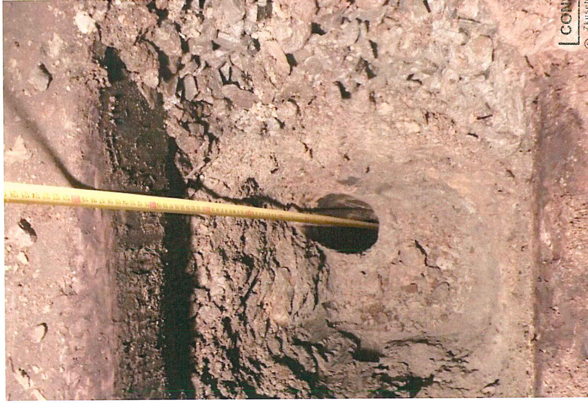
Foto č. 3 - Detail jednotlivých vrstev sondy S1
