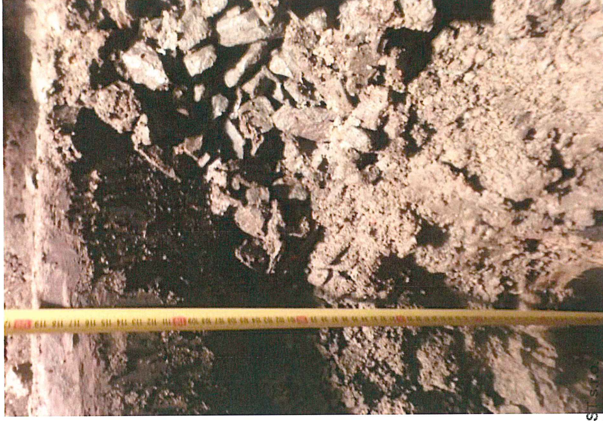
Foto č. 6 – Detail jednotlivých vrstev sondy S1
